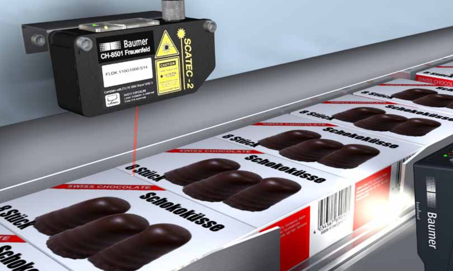
Einzelverpackungsdetektion bei lückenloser Produktförderung.
